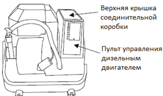
Рис. 18: Местоположение соединительной коробки
